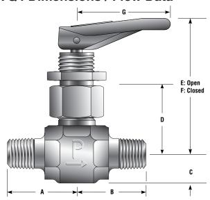
Panel Hole Diameter: VQ4: 0.52 (13.2) VQ6: 0.65 (16.5) Max. Panel Thickness: VQ4: 0.25 (6.4) VQ6: 0.35 (8.9)
