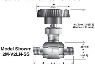
Panel Hole Diameter: 0.45 (11.4) Max Panel Thickness: 0.25 (6.4)
